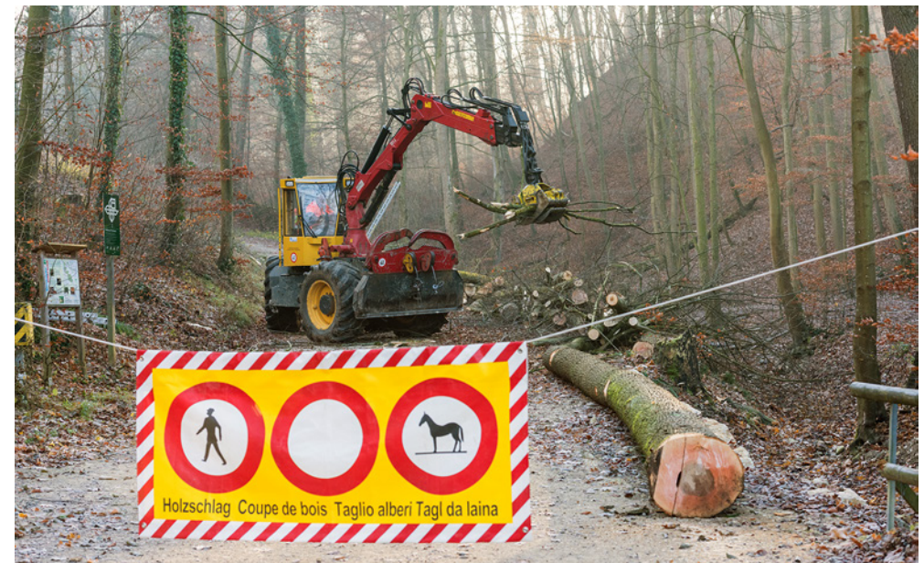
Im befahrbaren Gelände werden Forwarder, Forstspezialschlepper (im Bild) und Landwirtschaftstraktoren für das Holzrücken eingesetzt; Muttenz BL.
