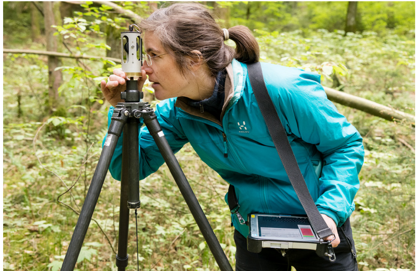
Vom Probeflächenzentrum aus werden mit dem Wyssen-Kompass die Azimute der Bäume und der Versicherungspunkte gemessen und im Feldcomputer erfasst.
